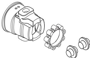
Регулярно проверяйте, чтобы на виброгасящих элементах не было трещин или деформаций. Проверьте, чтобы амортизатор был в целости и хорошо закреплен.
