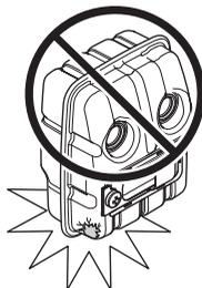
Периодически проверяйте, чтобы глушитель был надежно закреплен на корпусе машины.
