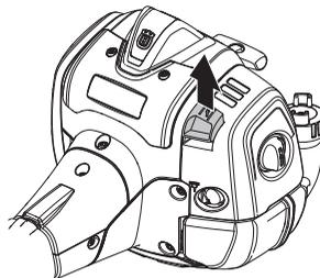
Достать воздушный фильтр, сняв крышку цилиндра. Промыть в чистой, теплой мыльной воде. Очистите крышку фильтра изнутри с помощью сжатого воздуха или щетки. Перед сборкой удостовериться, что фильтр сухой.
