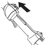
**ВНИМАНИЕ!** Контакт остановки автоматически возвращается в положение запуска. Во избежание непроизвольного запуска, колпачок зажигания следует всегда снимать со свечи зажигания при монтаже, проверке и/или обслуживании.
